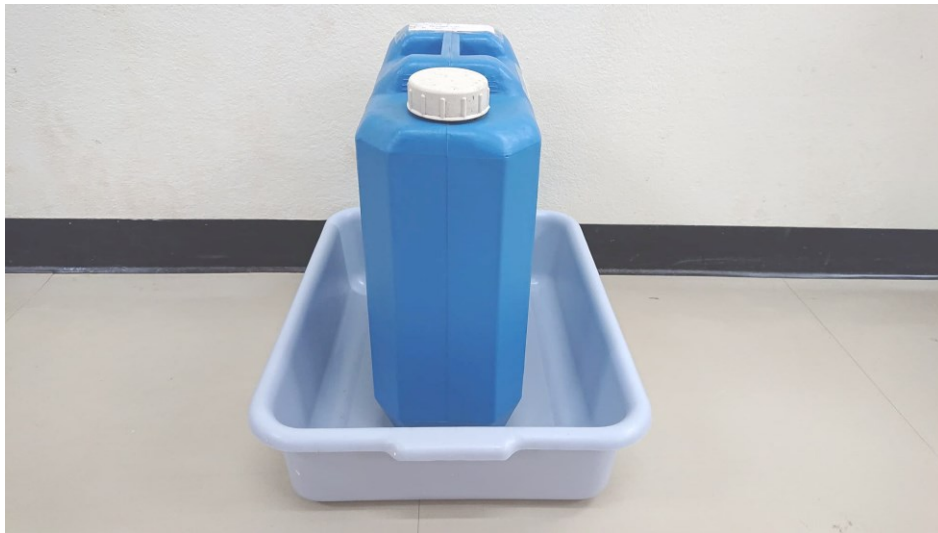
ตัวอย่างถังบรรจุสารเคมีชนิด HDPE พร้อมฝาปิด ขนาดบรรจุ 25 ลิตรที่วางในภาชนะรองรับที่มีปริมาตรเพียงพอสำหรับรองรับของเสียทั้งหมดในกรณีที่เกิดการรั่วไหล
